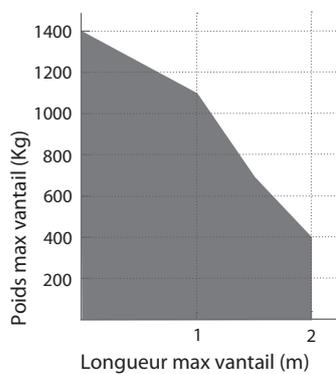
La forme du vantail, l'installation incorrecte et/ou la présence de vent peuvent compromettre les règles d'utilisation indiquée.
