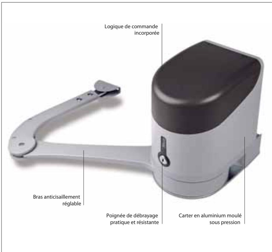
Pour portails battants avec vantaux jusqu'à 3,5 m, y compris avec piliers de grandes dimensions. Opérateur électromécanique irréversible, 24 Vcc, avec encodeur magnétique. À bras articulé, montage extérieur. Idéal pour un usage intensif.
