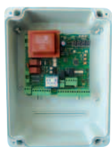
Centrale de commande
